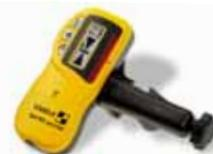
При использовании линейного ресивера REC 210 Line\* радиус действия 250 м.
