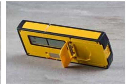
**Складная стойка** для позиционирования ресивера на полу.
