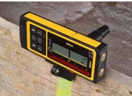
С помощью **крепёжного устройства** ресивер можно быстро и прочно установить на контрольной рейке.
