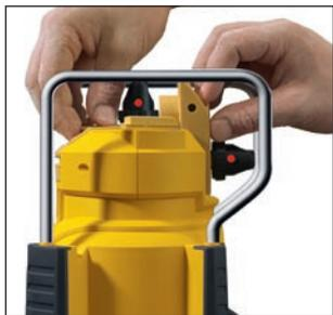
Перевод прибора из горизонтального в вертикальное положение: Блок призмы в комплекте, также переводиться при этом точно на 90°.
