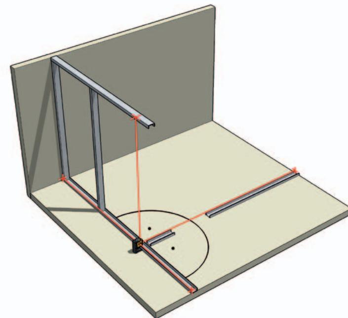
Оптимально для определения и переноса прямых углов. Для переноса планировки с пола на потолок, как для прямых, так и для стен с особыми формами. Для быстрого и точного определения соосности.
