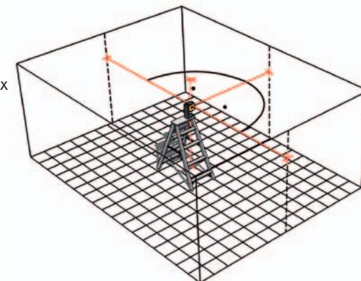
Прибор LA-5P: функция отвеса вверх и вниз с выдвижной ножкой. 3 горизонтальные точки создают два угла 90°.
